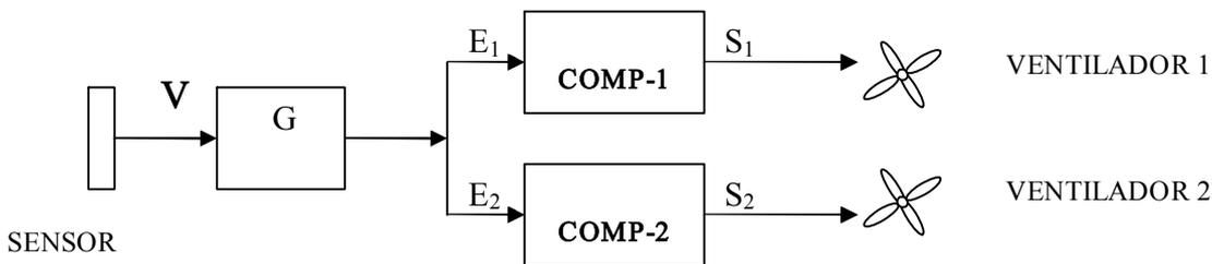
a) Obtenga el valor de la ganancia  $G$  para que el ventilador 1 se active con una concentración igual o superior a  $10 \text{ g/m}^3$ . (1 Punto)
